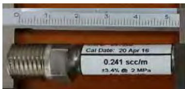
0.241sccm@2Mpa, 1/8NPT外螺纹
