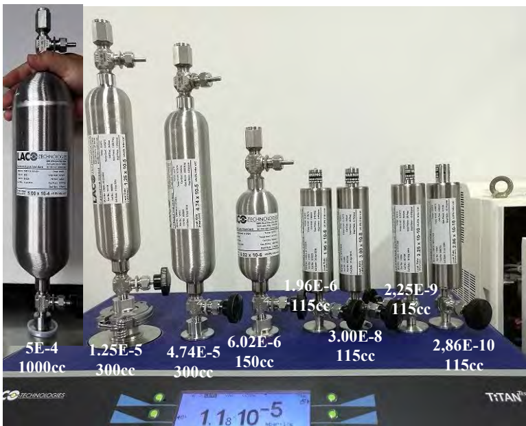
一组LACO TLS通道型标准漏孔 E-4 ~ E-10 mbar.L/sec
